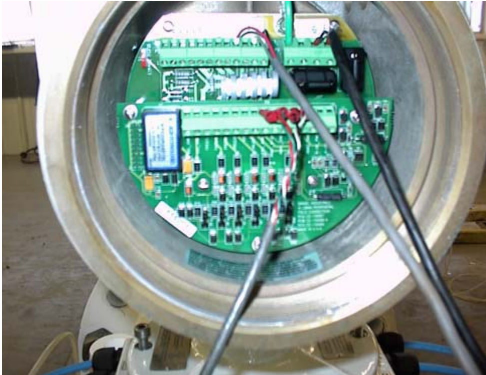
شکل ۳-۴۵: نمونه‌ای از فرستنده USM - فرستنده اطلاعات به صورت گسسته
