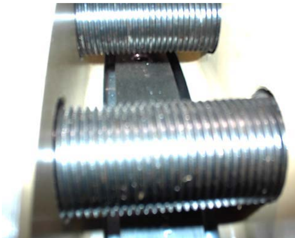
شکل ۳-۴۹: پیچ‌های داخل فلنجی برای دو قسمت ورودی به شکل‌دهنده و شکل‌دهنده به اندازه‌گیر
