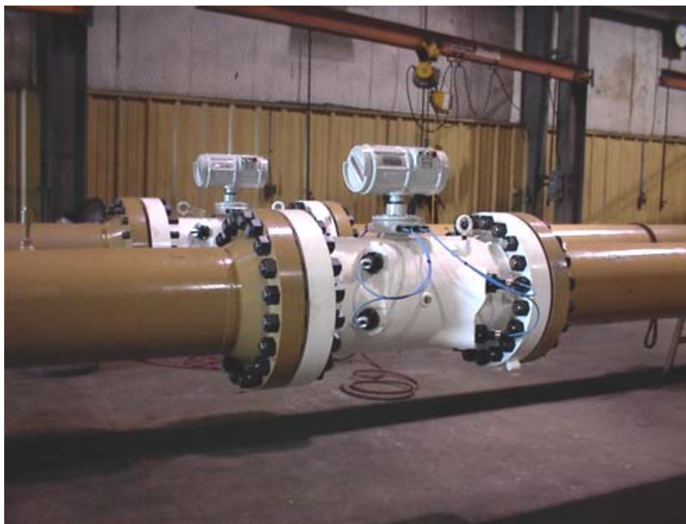
شکل ۳-۴: شماتیک یک USM (انتخاب المان‌های یک USM بر حسب کاربرد بسیار مهم است)
