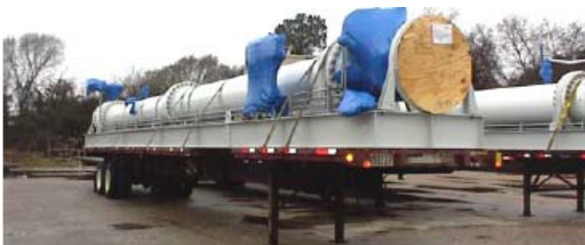
شکل ۳-۴: یک نمونه USM با طول ۱۲۶ فوت و وزن ۹۶۰۰۰ پوند با ظرفیت ۵ میلیارد پوند بر سال
