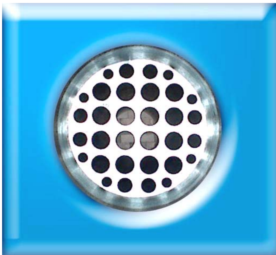
شکل ۳-۴۸: شکل‌دهنده جریان از نوع صفحه متخلخل ضخیم
